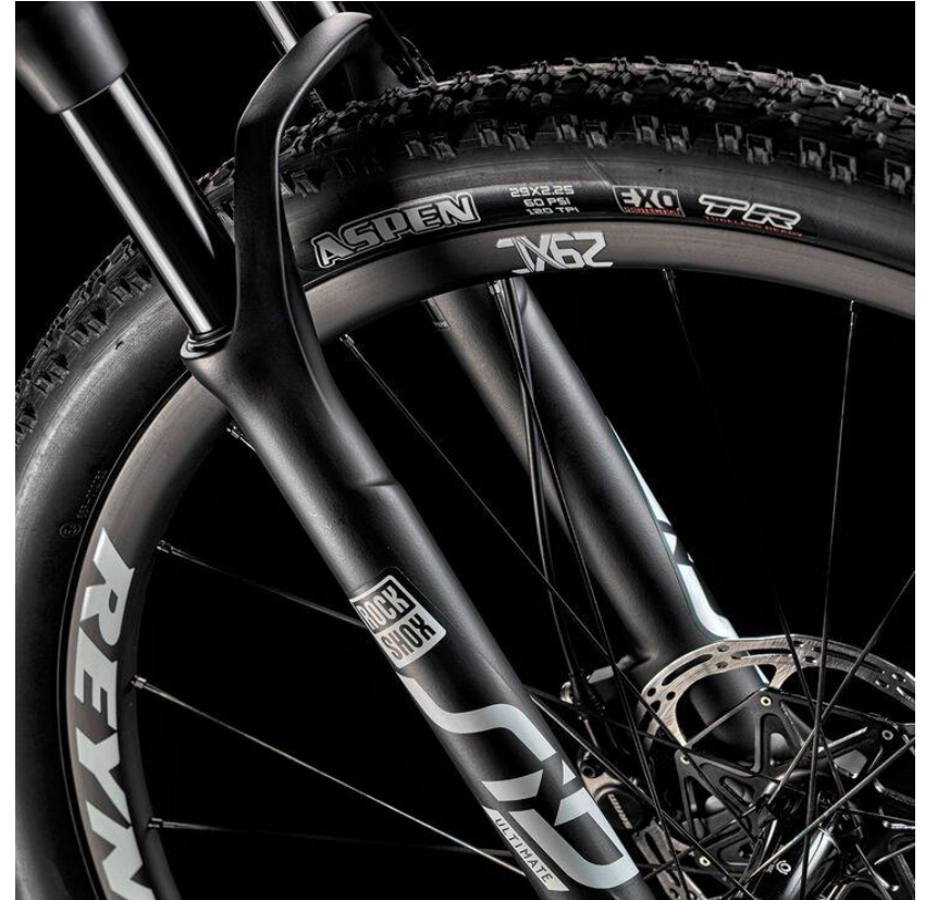
Roue avant (pneu, jante, rayons) - Fourche suspendue – Disque du frein avant
